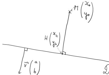
*Démonstration.* Avec les notations du dessin, on voit qu'il existe un réel  $t$  tel que  $\overrightarrow{HM} = t\vec{v}$  et donc on obtient  $d(M, \mathcal{D}) = \|\overrightarrow{HM}\| = |t| \times \|\vec{v}\|$ . Ainsi :
